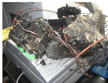
起火原因研判為該儀器的漏電斷路器過載而起火
