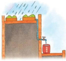
儲水能力來供應短時間的水分，盆栽式綠屋頂可使用較深的容器盛裝保水力強的介質。也可整體考量，設置「雨撲滿」承接雨水，發揮減緩雨水逕流的效果。
