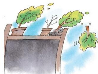
較高的植物有風折、風倒的危險，而綠屋頂的植物如跌落地面，將造成安全上的危害。因此控制植物高度、選擇生長緩慢的樹種，利用介質提供足夠的支持力，且繫綁支柱甚至加設地錨等設施，可更確保風災的安全性。
