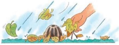
大雨時宣洩不及，使屋頂積水。這可藉由定期疏通排水管、在排水孔加裝高腳落水頭，或是女兒牆上加鑽排水孔以促進排水。
